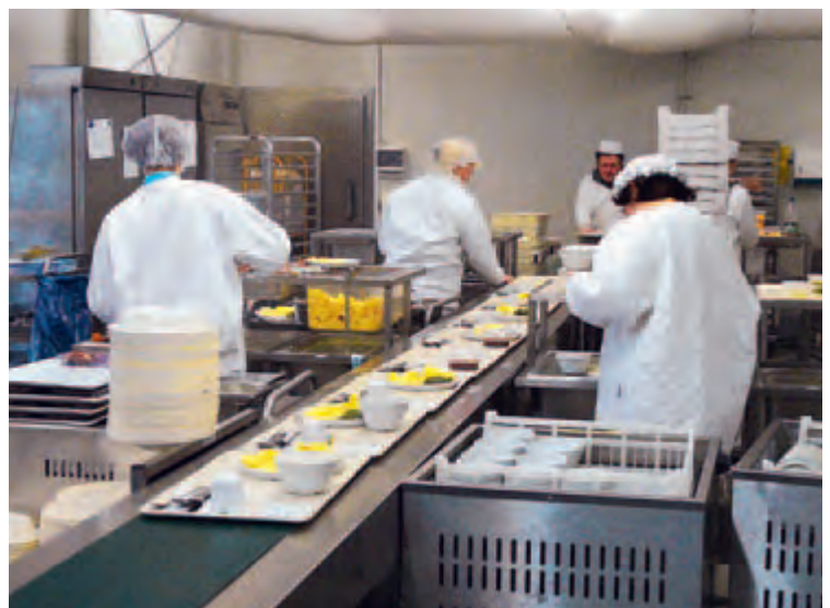
Die Bandportionierung der gekühlten Komponenten erfolgt bei einer Umgebungstemperatur von 8 – 10°C.
